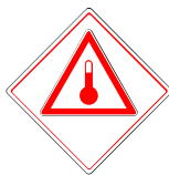
Marque pour les matières transportées à chaud
